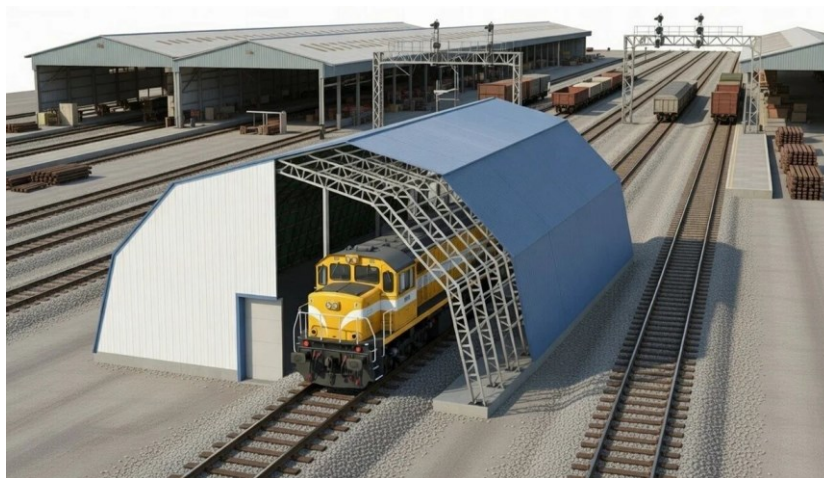
Рисунок 2 – Применение быстровозводимых ангаров на станционных путях
