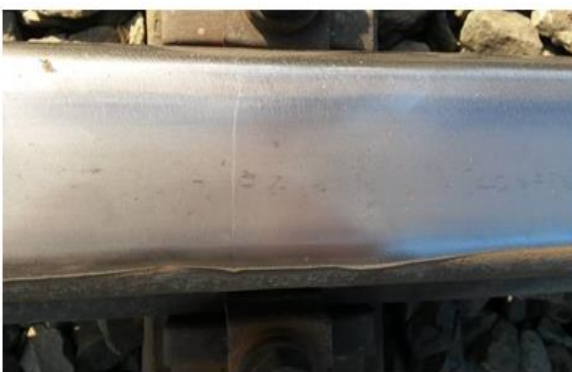
Рисунок 1.3 – Термомеханические повреждения головки рельса из-за боксования колес электровоза
