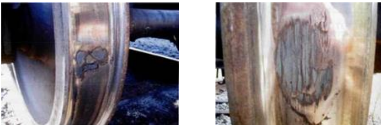
Рисунок 1.4 – Дефекты бандажа колесной пары электровозов 2ЭС6
