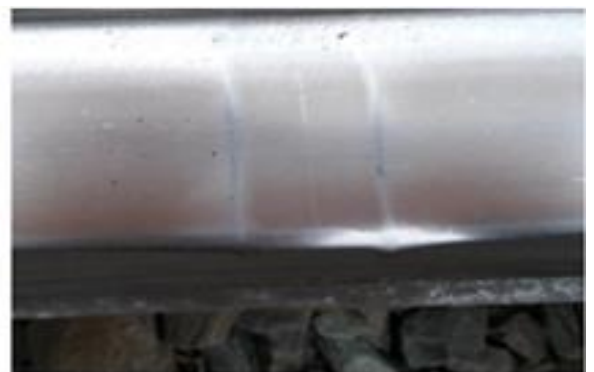
Рисунок 1.3 – Термомеханические повреждения головки рельса из-за боксования колес электровоза
