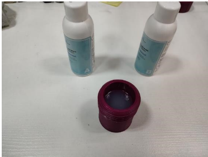
Рисунок 4.2 – Смешивание литьевого силикона в емкости для дегазации
