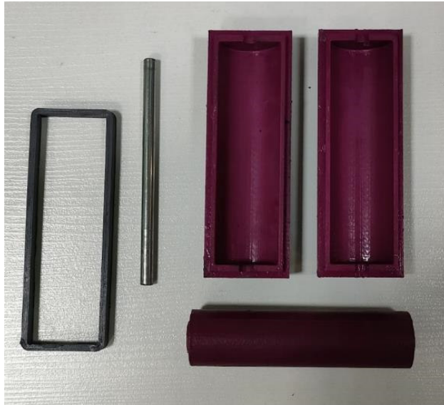
Рисунок 4.1 – Форма для отливки оболочек внутрипружинных пневмоэлементов
