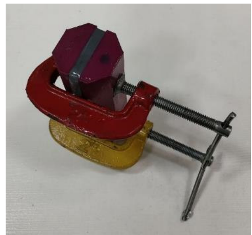
Рисунок 4.4 – Заливка литьевого силикона в форму для изготовления оболочек внутрипружинного пневмоэлемента
