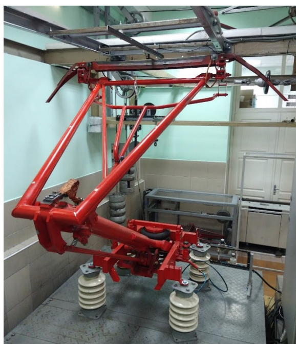
Рисунок 4.11 – Общий вид колебательного стенда для исследования динамических характеристик токоприемников
