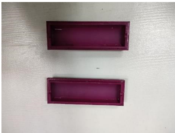
Рисунок 4.4 – Заливка литьевого силикона в форму для изготовления оболочек внутрипружинного пневмоэлемента
