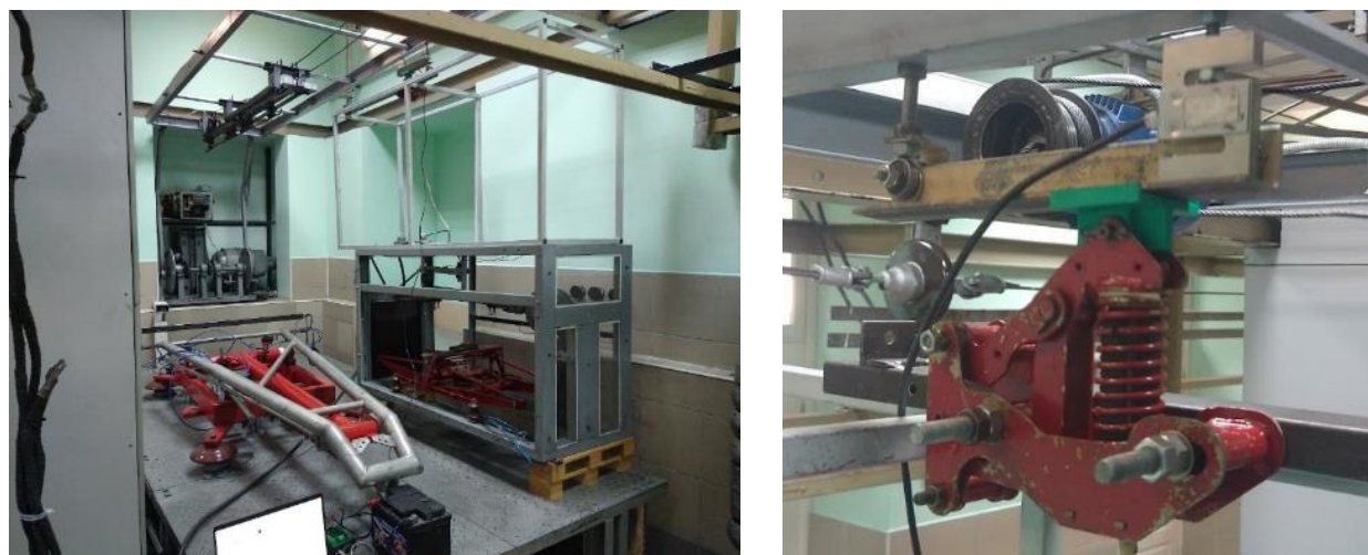
Рисунок 4.8 – Испытательной установки для определения износостойкости внутрипружинных пневмоэлементов: а – испытательное оборудование, б – процесс испытаний
