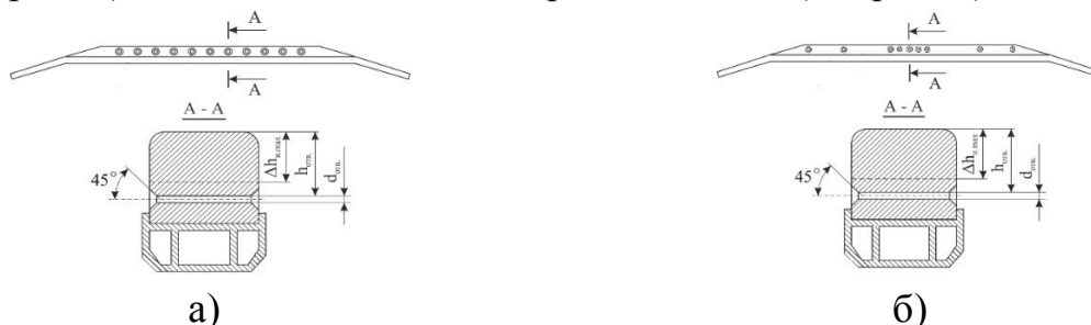
Рисунок 7 – Полозы токоприемника с равномерным (а) и дифференцированным (б) распределением отверстий конусной формы во вставке
