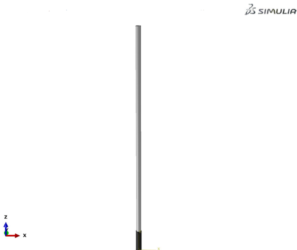
Рисунок 2 – Модель цилиндрической стойки в грунте, выполненная в программе ABAQUS
