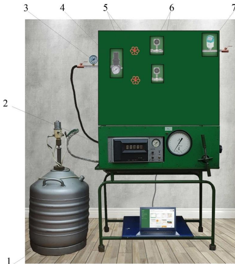
Рисунок 2 – Общий вид экспериментальной установки, используемой для формирования потока сжатого воздуха с заданной степенью влажности:
