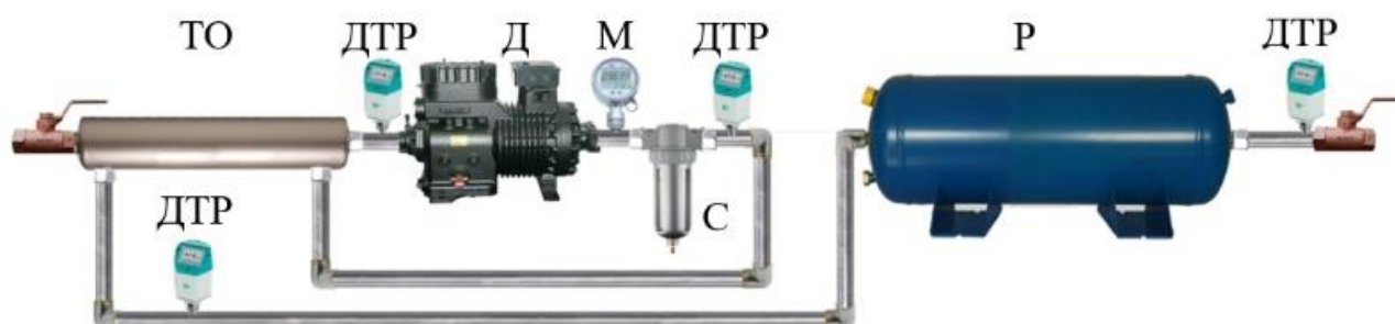
Рисунок 3 – Конструктивное исполнение макетного образца для установления степени изменения влажности газов от давления потока сжатого воздуха
