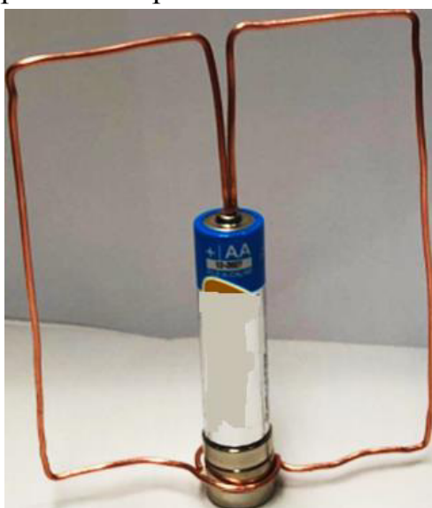
Рис. 2. Второй вариант изготовления униполярного двигателя
