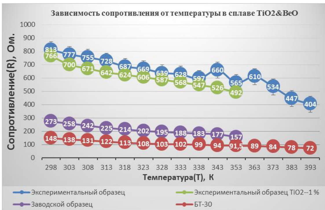
Рис. 5. Температурная зависимость электросопротивления для образцов бериллиевой керамики:
