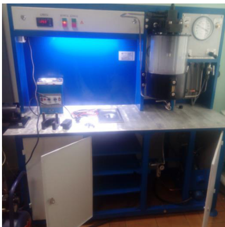
Рис. 2. Стенд по контролю технического состояния топливных форсунок
