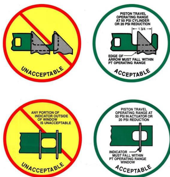
Рис. 1. Индикатор выхода штока тормозного цилиндра с расположением исполнительной части на тележке
