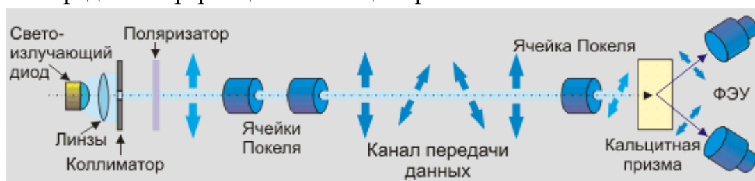
Рис. 1. Схема процесса передачи информации с помощью фотонов
