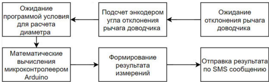
Рис. 2. Поэтапная блок-схема принципа действия устройства
