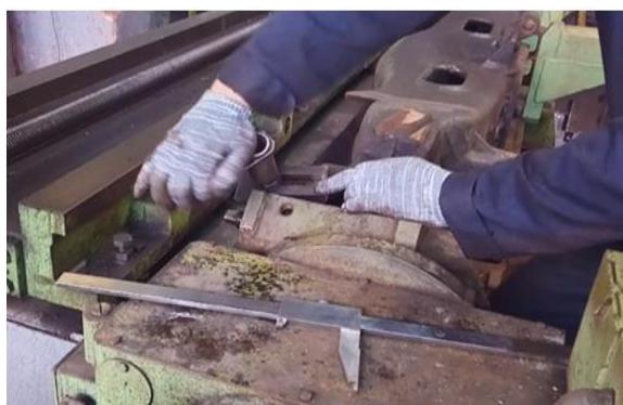
Рис. 1. Установка надressорной балки в приспособление
